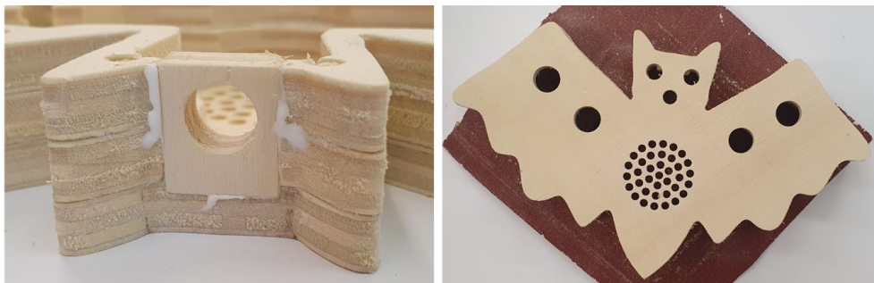
Abbildung 22: Einleimen der Halterung für den Ultraschallempfänger (Trocknungszeit etwa 15–20 Minuten) (eigene Darstellung)
