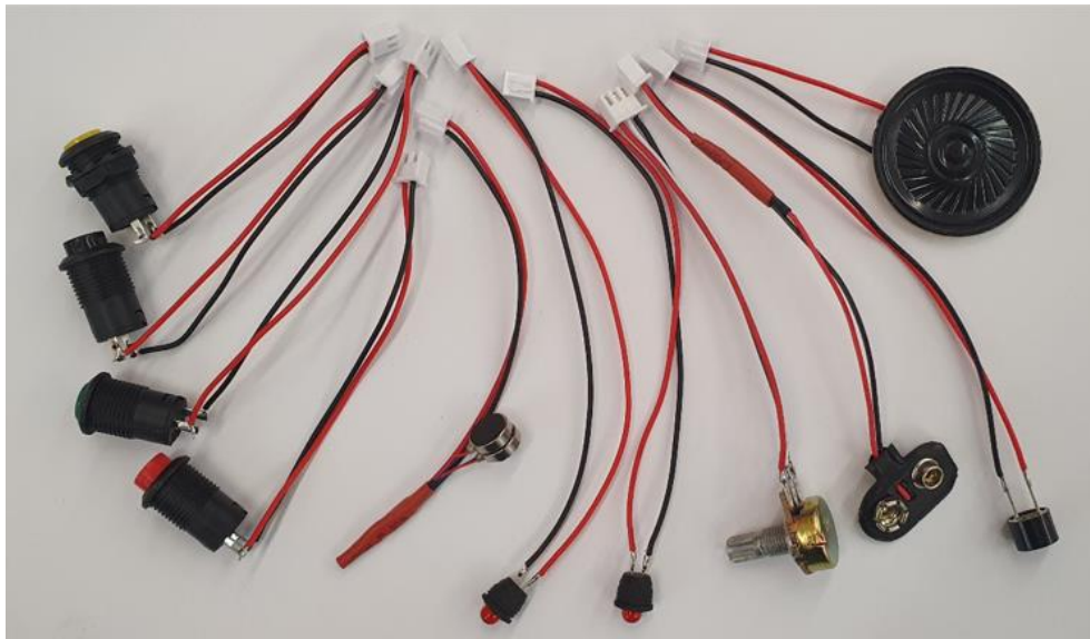
Abbildung 23: Komponenten mit entsprechenden Anschlusskabeln (eigene Darstellung)
